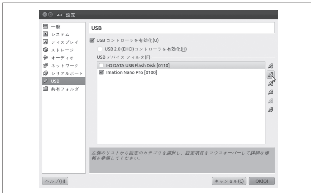
図A-4 USBの設定画面。「+」アイコンをクリックしてフィルタを設定する
