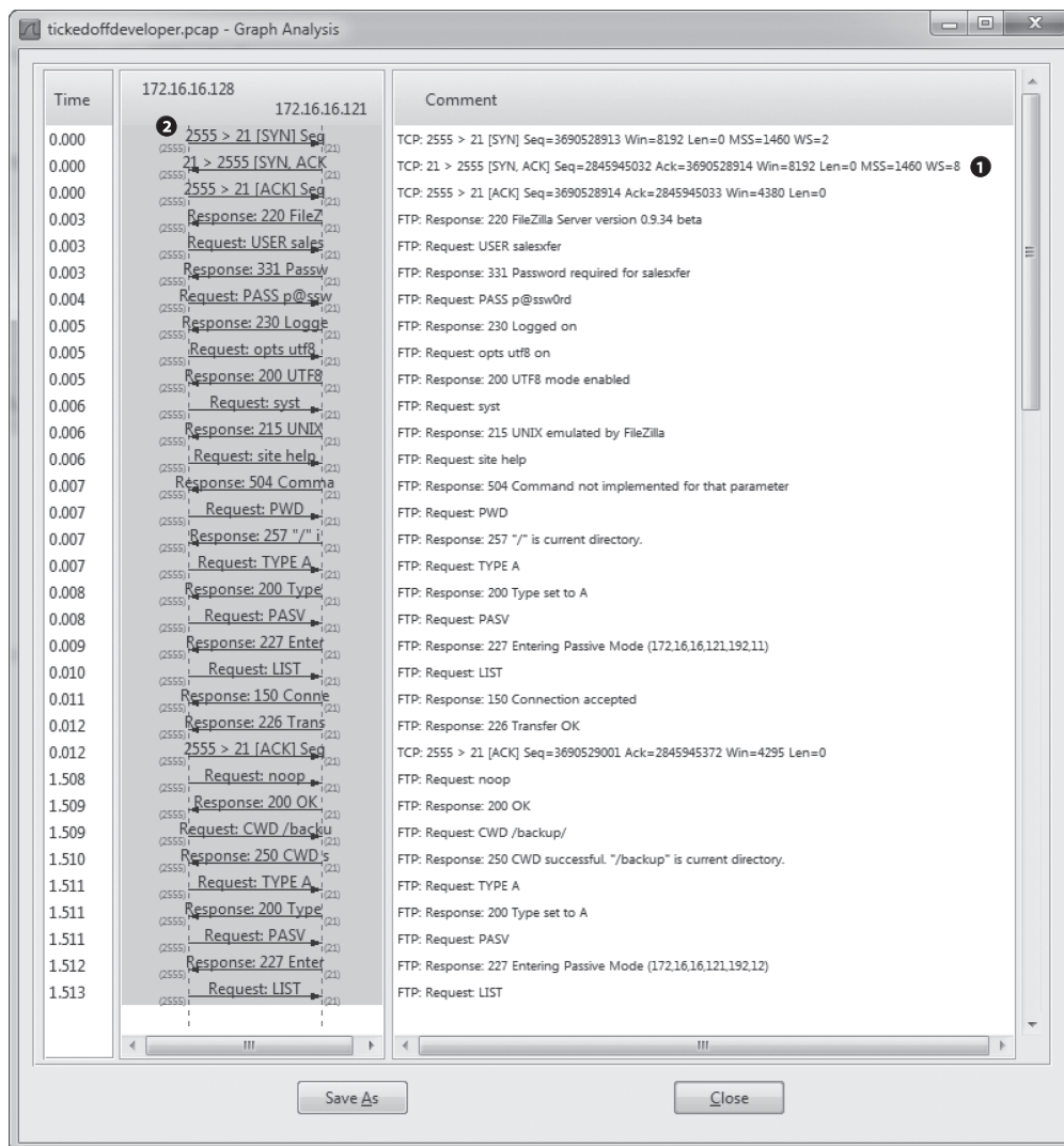
図8-37 フローグラフでFTP通信がひとめでわかる
