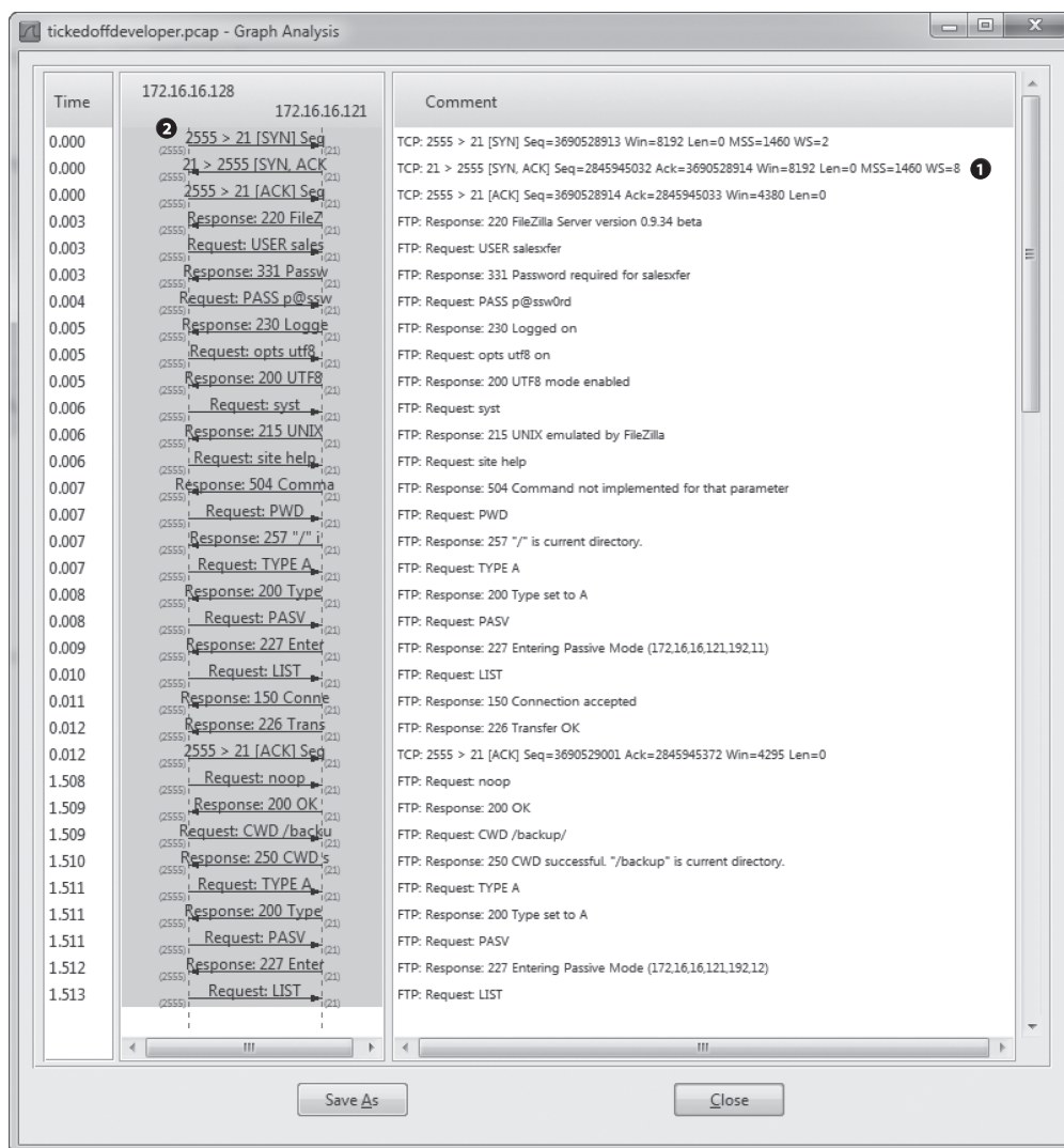
図8-37 フローグラフでFTP通信がひとめでわかる
